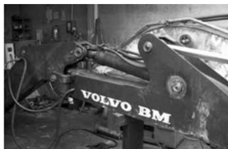
Figura 3: Sistema de movimiento de arena del cargador frontal L-120 B.
