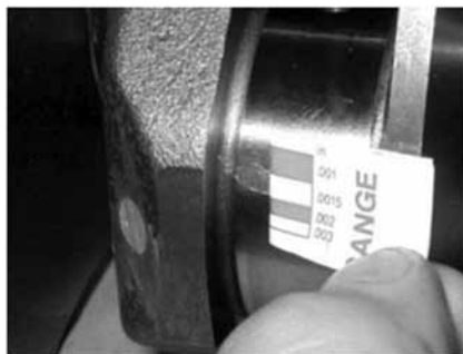
Figura 5: Medición de la tolerancia de ajuste
