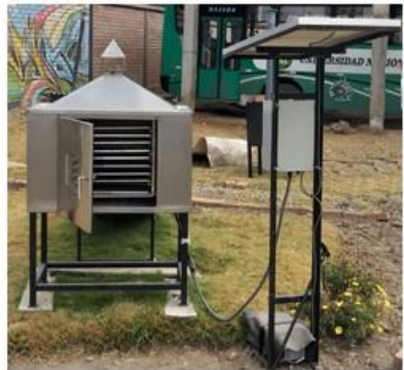
Parte posterior del secador solar autónomo indirecto de la Facultad de Ciencias Aplicadas de la Universidad Nacional del Centro del Perú – Filial Tarma
