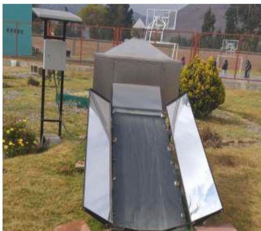
Secador solar autónomo indirecto de la Facultad de Ciencias Aplicadas de la Universidad Nacional del Centro del Perú – Filial Tarma
