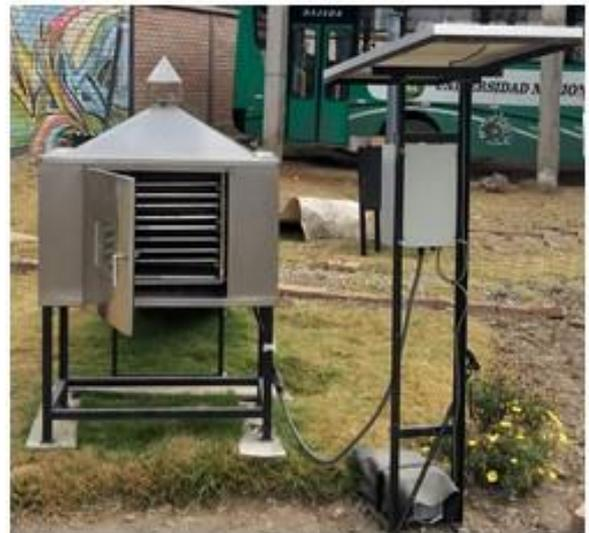
El sistema de control consta con energía almacenada en una batería proveniente de la energía fotovoltaica producida por el panel solar y para los controles cuenta con un tablero de control. Esta alternativa energética depende de la radiación solar para calentar el aire y dar electricidad solar a los controles por lo que se dice que es autónomo.
